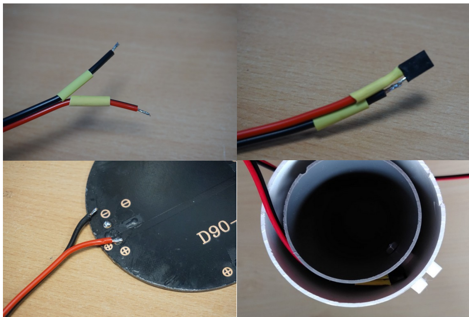
Foto 26: connector verbinden aan het zonnepaneel en door de buizen heen halen
