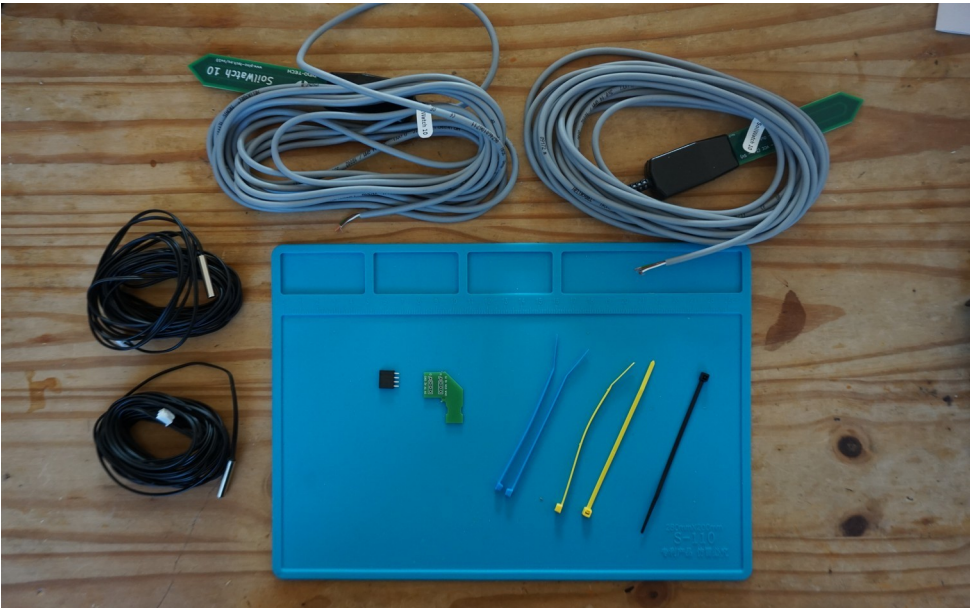
Foto 14: materialen om de connector van de bodemvocht-sensoren te maken.
