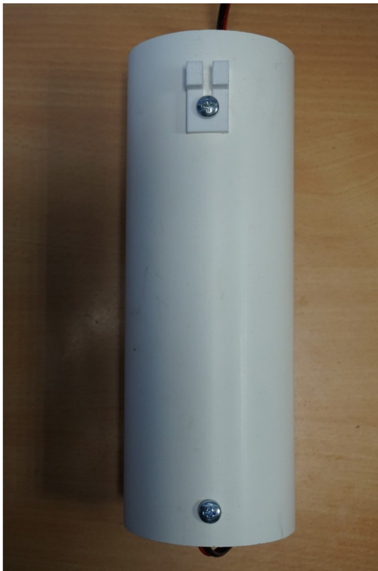
Foto 25 :buizen aan elkaar verbonden, met borgplaatje aan de bovenkant.
